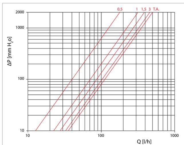
**Perdite di carico R304T versione bitubo con apertura corrispondente a  $\Delta t = 2^\circ\text{C}$**
