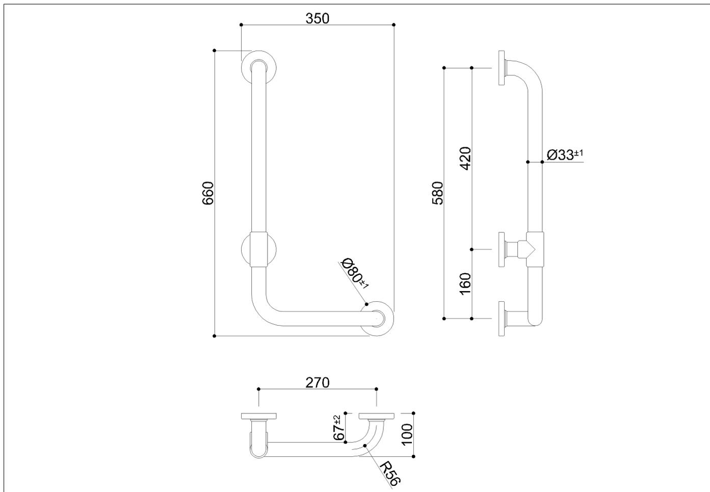
Maniglione di sicurezza a "L", realizzato con tubo di acciaio zincato rivestito con vinile biocompatibile e caldo al tatto
