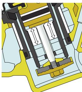
La particolare sezione della zona di passaggio tra la sede e la tenuta dell'otturatore consente un comportamento stabile alle variazioni di pressione di monte e il funzionamento con portate elevate, con ridotto rumore dovuto al passaggio dell'acqua.
