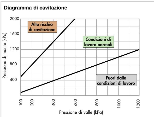
Al fine di ridurre al minimo il rischio di cavitazione all'interno del riduttore, che potrebbe provocare malfunzionamenti con rischio di erosione nella zona di tenuta, vibrazioni e rumore, è fortemente consigliato fare riferimento alle condizioni di lavoro riportate nel diagramma.
