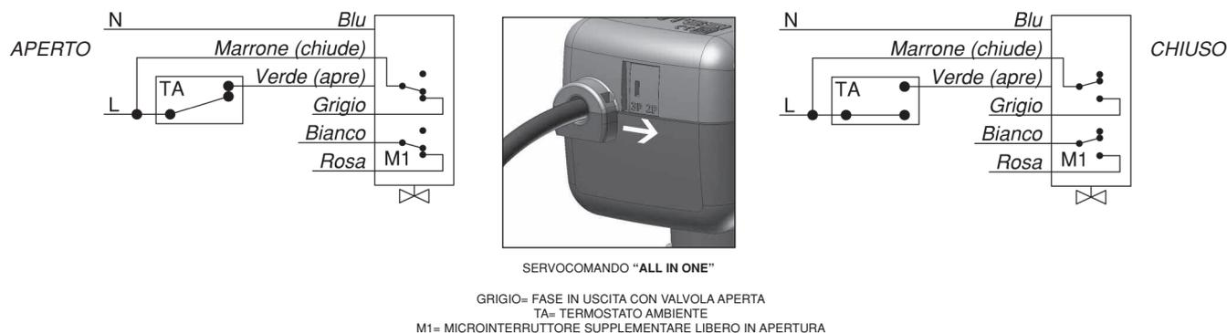
Le figure rappresentano lo schema elettrico del servocomando con comando a **2 PUNTI**.
