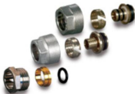
Luxor produce una vasta gamma di raccorderia a stringere per soddisfare tutte le tipologie di installazione. Sono compresi raccordi per tubo rame (o acciaio dolce), tubi in polietilene (polibutene o polipropilene) e tubi in multistrato (PEX-AL-PEX). Tutte le superfici interne sono prive di trattamenti galvanici, ciò rende conforme al D.M.174 per il trasporto di acqua potabile.
