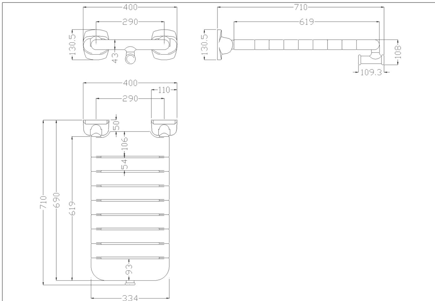
Sedile ribaltabile con seduta in doghe di nylon, realizzato con tubo di acciaio zincato rivestito con vinile biocompatibile, caldo al tatto
