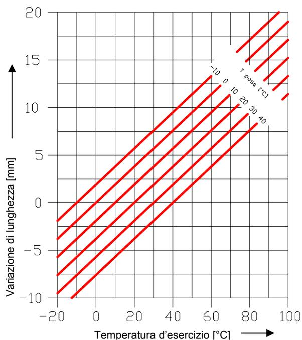
Il diagramma a lato considera la dilatazione lineare di 1 m di tubo (misurato alla temperatura di posa  $T_{\text{posa}}$ ), appena questo viene messo in esercizio.
